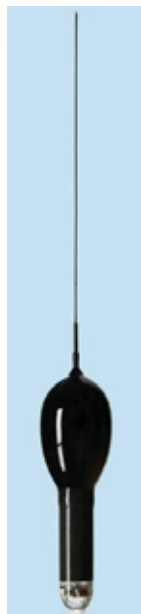
圖 5 上脫型衛星 記錄標識器 X-Tag
