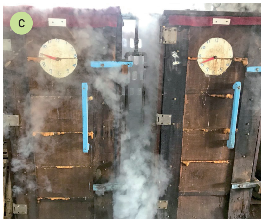
圖 6 A：將浸泡鹽水後的魚隻鋪平在竹篩上疊至一車；B：推入高壓蒸氣鍋爐；C：以 400 度高溫 8 分鐘蒸熟，即可拉出來靜置冷卻
