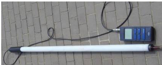
圖5 pH/ORP meter 本體及測量 ORP 用的白金電極
