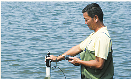
圖6 ORP 數值可直接在養殖池測得
