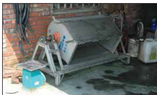
圖 7.22 使用鰻粉加水及添加物調配成餌料團 餵飼池鰻的養殖場，設置之飼料攪拌機於攪拌完成後應清洗機械及保持機械設備周圍環境的清潔
