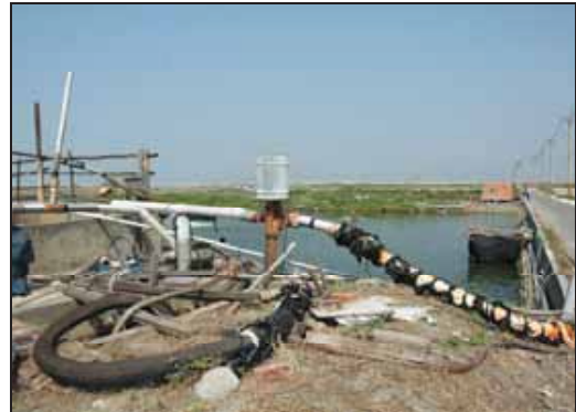
圖 7.14 為了節省人力，採用自動化機械，圖中設備為自動送鰻機，將池鰻直接送到蓄養池
