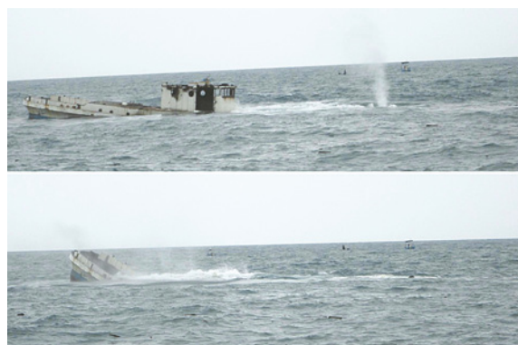
海建號船礁爆破下沉
