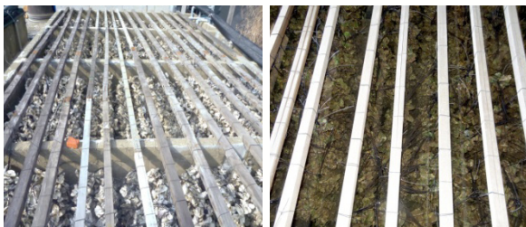
圖 4-10 本中心使用吊掛的燒烤牡蠣殼做為生物濾材，提供硝化細菌附著
