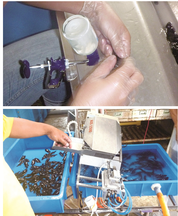
圖 4-19 人工注射 GIV 疫苗(上)；使用自動注射機注射 GIV 疫苗(下)
