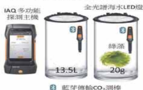
圖1 利用生態缸建立藻類CO 2 量測方法
