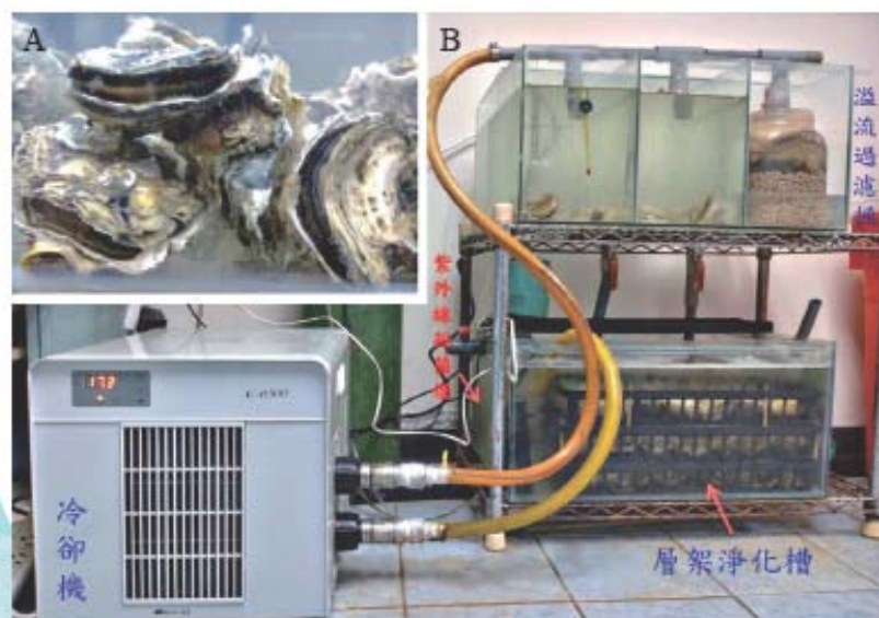
圖 1 建立一微型淨化系統，進行牡蠣衛生安全之確效 (A：國產單顆帶殼牡蠣；B：組裝之微型淨化系統)
