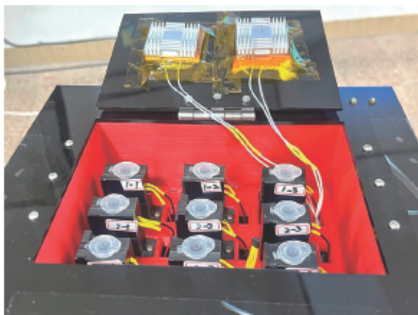
圖 1 陣列式光學數位病原菌檢測系統
