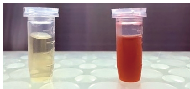
圖 2 芽孢桿菌快速檢測套組的呈色反應
