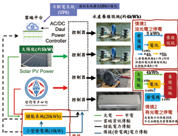
圖 1 韌性能源養殖光電自電自用模組之裝置設置圖
