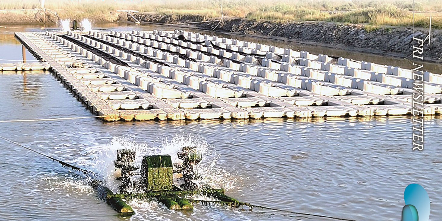
圖2 近年來許多養殖戶嘗試使用變頻水車，它的外型經過多次的改良，轉盤的軸往內縮且轉速可以調整，這樣處理可以降低機器故障機率 (曾威騰及盧閔霖攝影)
