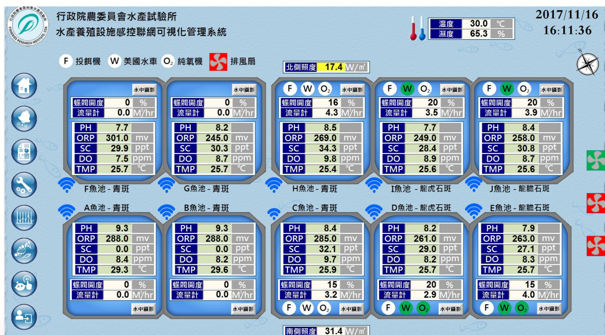
圖 9-3 水產養殖設施感控聯網可視化管理系統操作介面
