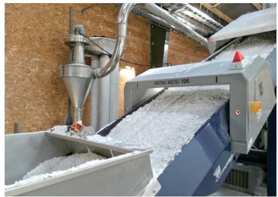
圖 6 將保麗龍魚箱回收加工成塑膠顆粒，再將其出售給製造商生產各種新產品 (資料來源：歐盟)
