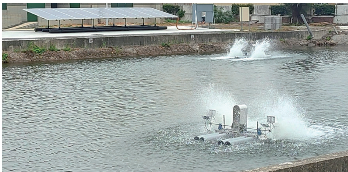
圖 2 光電系統結合水車自電自用試驗現場圖
