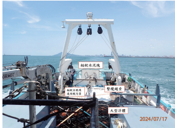
圖 5 中層人工浮魚礁在水試二號試驗船上的配置方式
