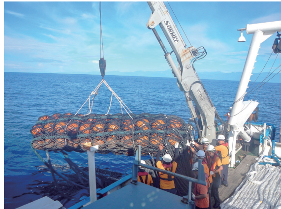
流程 2 吊掛大型浮體入海
