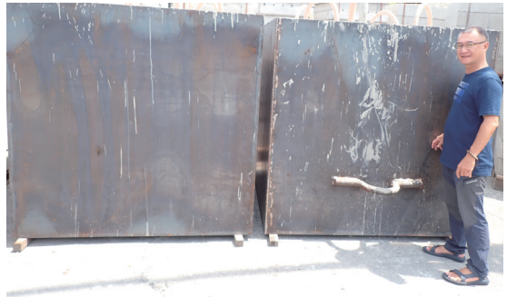
圖 2 錨錠用的鋼鐵箱水泥塊，尺寸約 1.7 m
