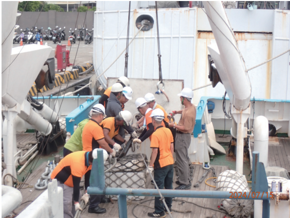
圖 4 錨鉋用的鋼鐵箱水泥塊的吊掛作業，需符合船後坡道作業安全的方向
