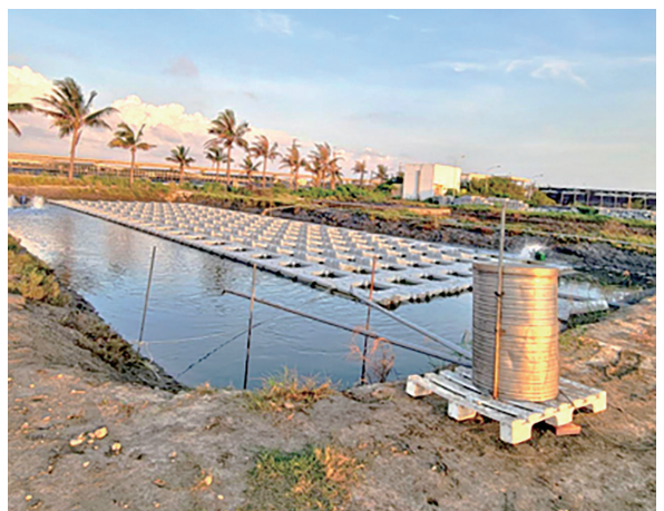
圖 3 模擬浮動型漁電共生養殖池，池子上方浮筏的遮蔽率為 70%
