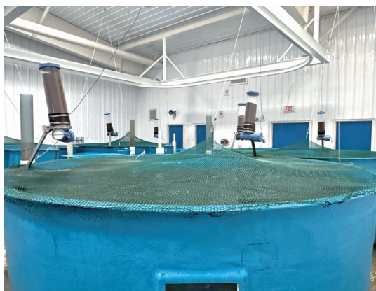
圖 3 鮭魚養殖試驗區、上方自動投餵機器手臂及工作軌道
