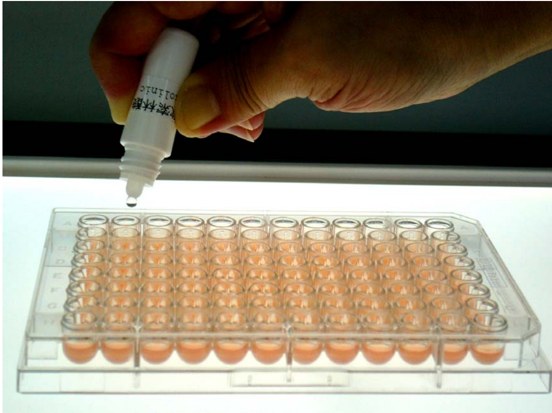
圖二 準備工作 。使用前，將6支試劑（對照組、氟甲磺氯黴素、氟滅菌、歐索林酸、羥四環黴素、磺胺一甲氧嘧啶），依序滴1滴在E2-kit檢驗盤上。
