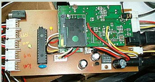
圖 3 GPRS/藍芽資料擷取及傳輸電路裝置
