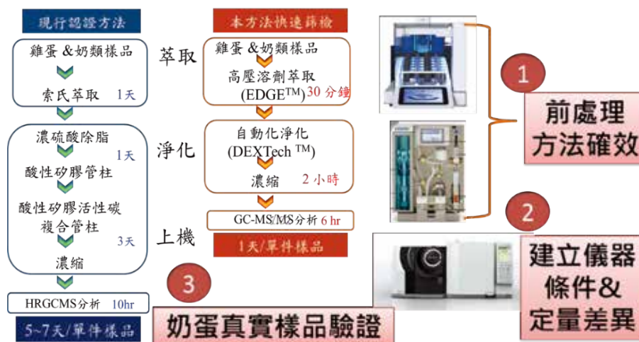
圖 66. 快速檢驗流程與公告方法流程的差異。
