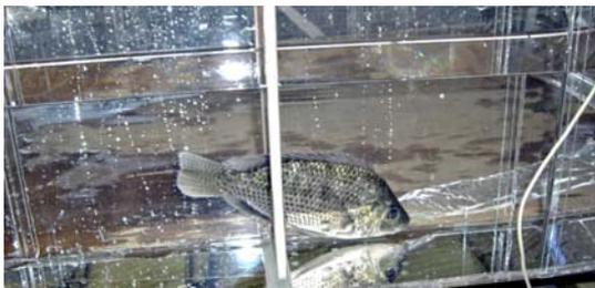
圖 6 吳郭魚活體通過水中感應線圈之情形
