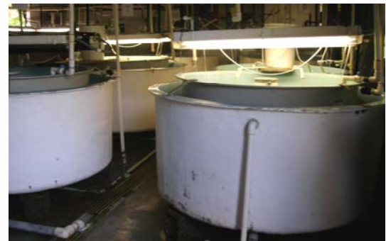
圖 7 黃鰭鮪種魚飼育池之蛋白質除沫器、打氣增氧水塔及其供水系統
