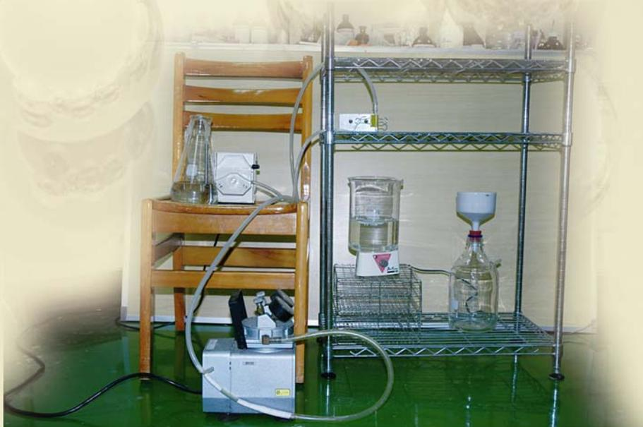
圖 1 海藻膠微膠囊製作的簡易設備圖示。地上為打氣馬達，椅子上分別為 1.5% sodium alginate 水溶液、蠕動馬達和乳膠管(含末端黃色 tip)，鐵架上由上而下依次為打氣管、22 號針頭、含 2%  $CaCl_2$  水溶液燒杯、電磁攪拌器等
