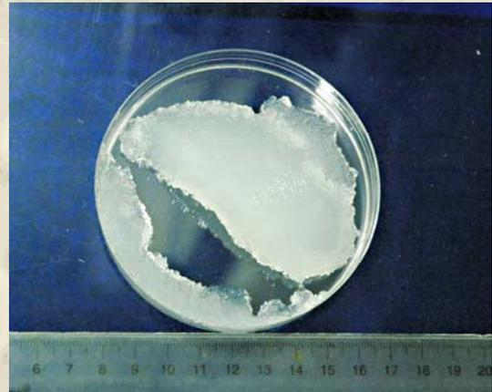
圖 4 過濾完成的海藻膠微膠囊，不含添加物的微膠囊呈現透明感
