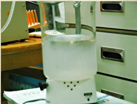
圖 2 海藻膠微膠囊製作的簡易設備圖示，2%  $\text{CaCl}_2$  水溶液燒杯中已經出現大量的海藻膠微膠囊
