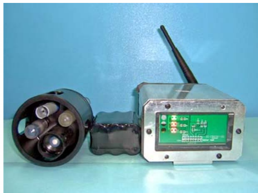
圖 1 水質電極、鋰電池及 Zigbee 終端/路由器模組 (圖左至右)
