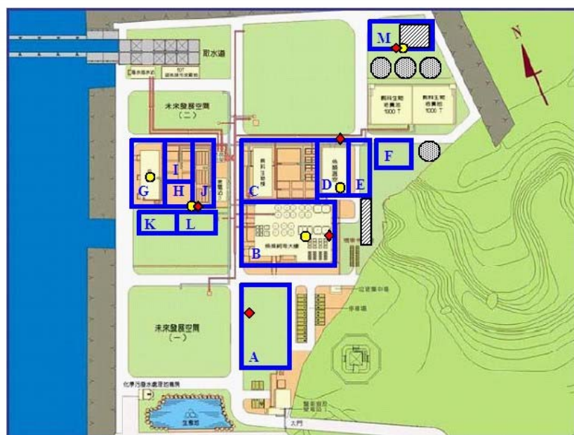
圖 4 本所澎湖水產種原庫之 Zigbee 監測系統俯瞰配置圖(黃色點為 Zigbee 調協器，紅色點為 WiFi AP)
