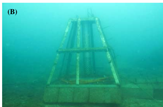
圖 7 底碇式水質監測系統之傳輸控制箱(A)、水下水質儀(B)設置情形
