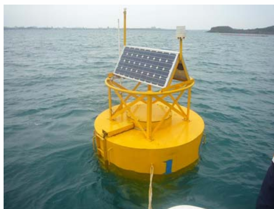
圖 5 WSN/Zigbee 觀測浮標錨碇作業與結附示意圖及 1 號次浮標(Slave-1)完成照片
