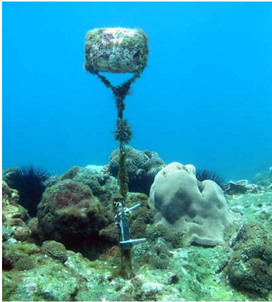
圖 2 澎湖海域養殖漁業渡冬候選地點連續溫度記錄器水下設置情形
