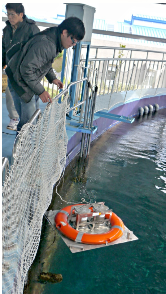
圖 4 以水下攝影鏡頭擷取鮪魚照片以獲得體長資料
