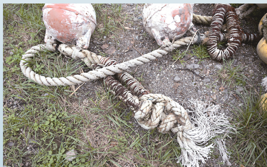
圖 1 蘇迪勒風災造成宜蘭地區多組定置網斷纜流失
