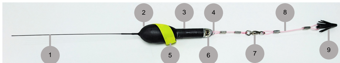
圖 1 高頻度彈脫型衛星標識器的各項裝置：(1)天線；(2)浮力與壓力感應器；(3)熱敏電阻感應器；(4)電解分離連接環；(5)磁鐵，移除後即進入開機狀態；(6)光照度感應器；(7)單培林轉環；(8)碳纖線；(9)傘型鏢頭
