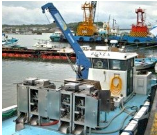
圖 19 漁獲運搬船上大型起網手臂與去鰓省工機械裝置（圖片來源： http://kurosui.jp/ ）
