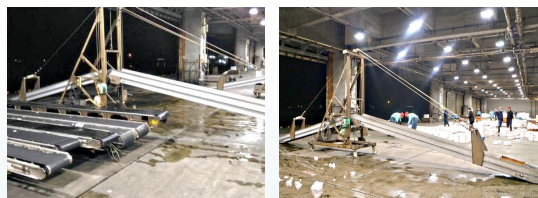
圖 15 沿近海小型漁船用之電動輸送帶（左圖）與斜臂支架（右圖）
