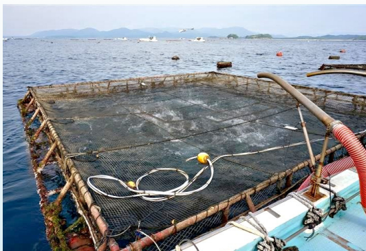
圖 18 餵飼專用船上之雙管機械自動計量投餌機
