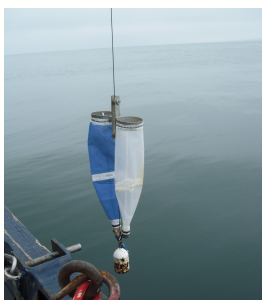
圖 7 投放 Pairovet 網具至 70 m 後垂直上揚
