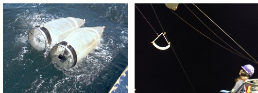
圖 9 將 Bongo 投放至 210 m 以斜拖方式上揚，並記錄角度變化
