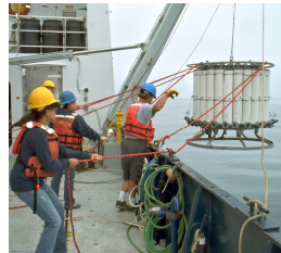
圖 3 輪盤採水器投放作業
