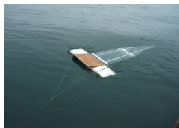
圖 8 Manta 網具以水平方式拖曳 15 分鐘
