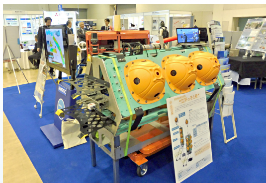
圖 4 日本研發超深海無人探測器「江戸子 1 號」，曾成功探測水深 7800 米的深海魚類
