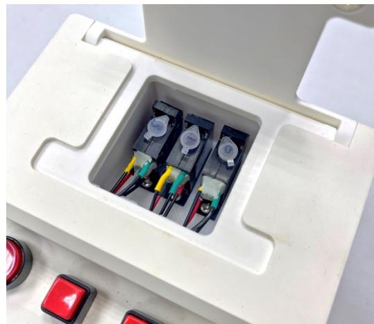
圖 1 檢測區包括三組獨立檢測槽
