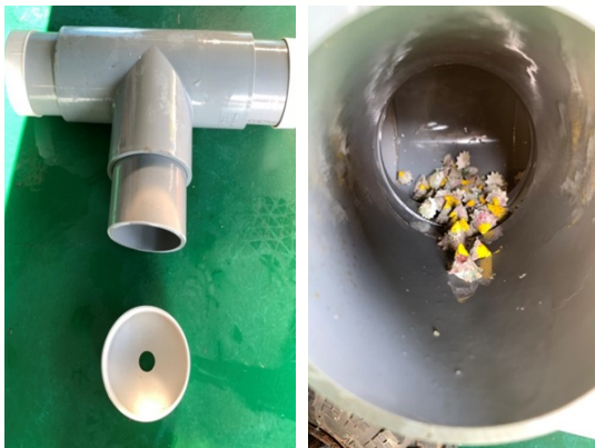
圖 1 6-8 英吋 PVC 三歧管加裝管套示意圖
