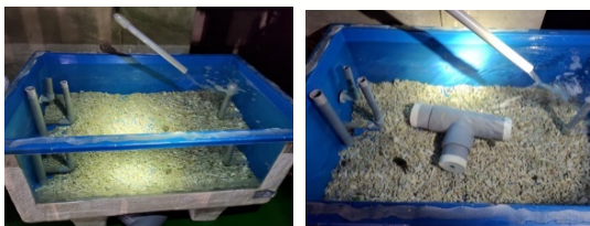
圖 2 方形 FRP 桶及 PVC 三歧管置放示意圖
