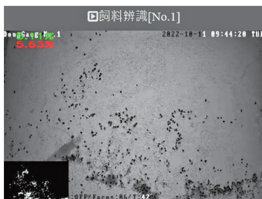
圖 3 智慧水下影像辨識系統辨識影像畫面的飼料面積比例
